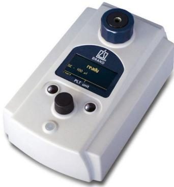
La causa más frecuente de inexactitud en las pipetas de pistón son las fugas. Esto se debe a daños en los sellos, pistones o conos de punta. A menudo, las fugas no son detectables a simple vista y provocan errores de volumen importantes. El comprobador de fugas de pipetas BRAND (unidad PLT) para pipetas de desplazamiento de aire detecta incluso las fugas más pequeñas en cuestión de segundos.
