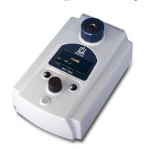
La causa más frecuente de inexactitud en las pipetas de pistón son las fugas. Esto se debe a daños en los sellos, pistones o conos de punta. A menudo, las fugas no son detectables a simple vista y provocan errores de volumen importantes. El comprobador de fugas de pipetas BRAND (unidad PLT) para pipetas de desplazamiento de air e detecta incluso las fugas más pequeñas en cuestión de segundos.
